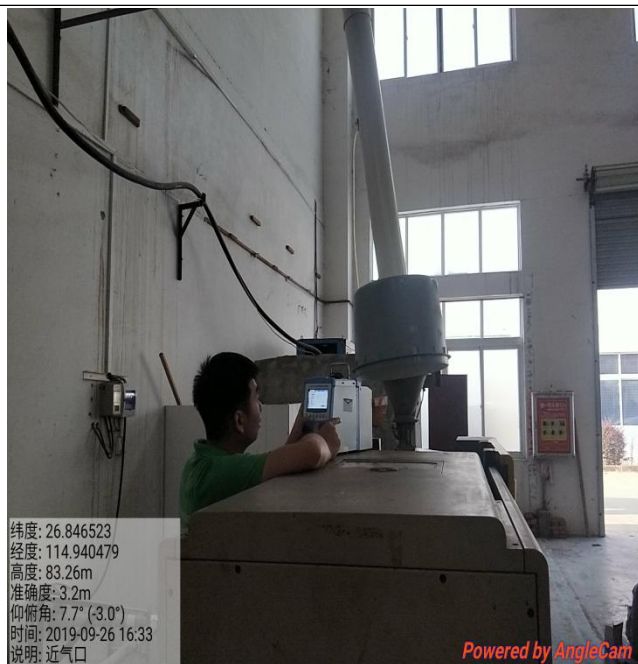
苯乙烯采样进口
