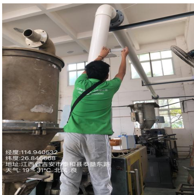
非甲烷总烃采样进口
