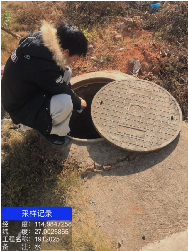
生活污水出口采样
