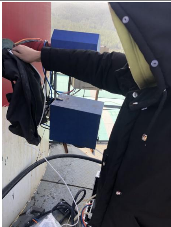
有组织原料处理工段排气筒出口颗粒物采样
