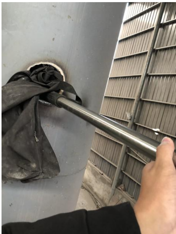
有组织原料处理工段排气筒出口颗粒物采样
