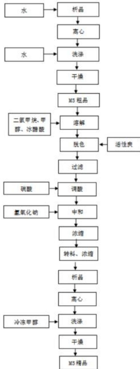
图 3.5.5 甲基泼尼松龙格氏物工艺流程
